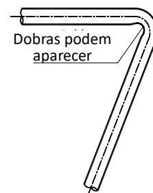
Figura 3-5.3: Arqueamento de tubos em mais de 90^\circ
