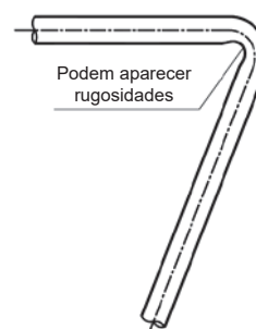
Figura 3-5.3: Curva de tubo com mais de 90^\circ
