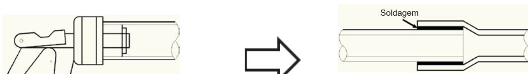
Figura 3-5.1: Expansão das extremidades da tubulação de cobre
